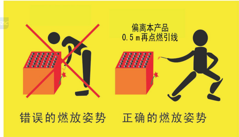
图 B.2 安全点燃方法示意图
